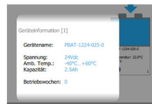
*Diese Geräteinformationen sind nur in Verbindung mit kompatiblen Speichermodulen mit Kommunikationsleitung verfügbar.*
