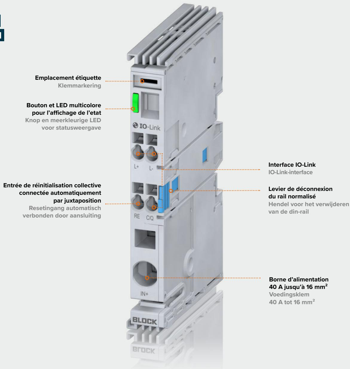
Les **modules de communication** servent d'interface pour la connexion au dispositif de commande principal. Les disjoncteurs de types EB-08, EB-18, EB-38, EB-07, EB-17 et EB-37 sont compatibles. Il est ainsi possible de collecter et de transmettre des informations concernant les états de fonctionnement et d'erreur, ainsi que de configurer et de commuter à distance jusqu'à 40 voies de disjoncteur.
