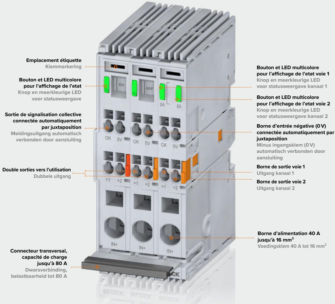
L'association de disjoncteurs à un contact de signalisation constitue une solution d'entrée de gamme pour une protection aisée. Le contact de signalisation permet une signalisation groupée (variante -0) ou individuelle (variante -4) pour un diagnostic et un suivi aisés des circuits défaillants.
