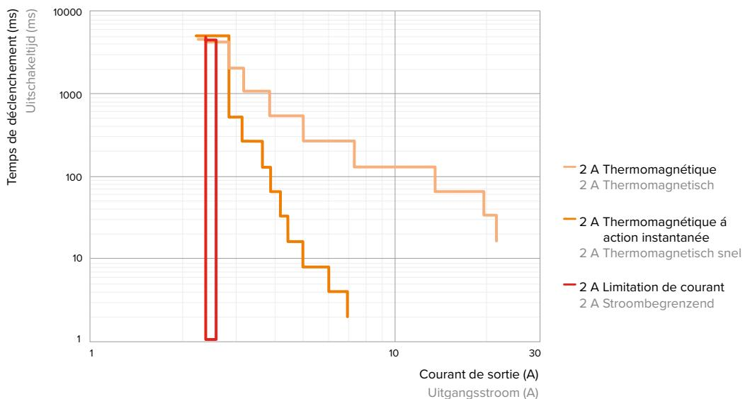
Les disjoncteurs électroniques ont été tout spécialement adaptés au comportement des convertisseurs continu-continu et des récepteurs 24 Vdc à alimenter. Ils distribuent le courant de charge entre plusieurs circuits afin de protéger efficacement les récepteurs raccordés et leurs câbles d'alimentation même si ceux-ci sont particulièrement longs et fins.
