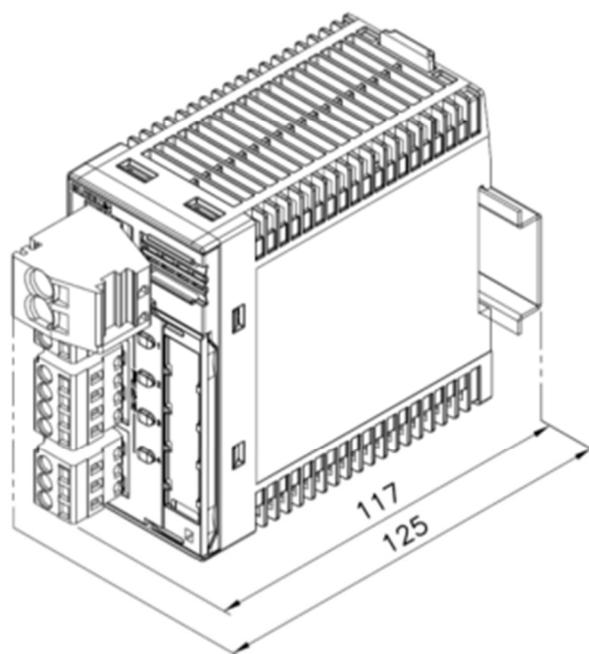
**Abmessungen 4/2-Kanal-Module mit steckbarer Anschlussstechnik**
