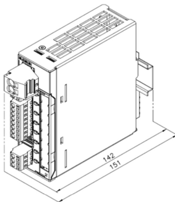
**Abmessungen 4-Kanal-Module mit steckbarer Anschlussstechnik**
