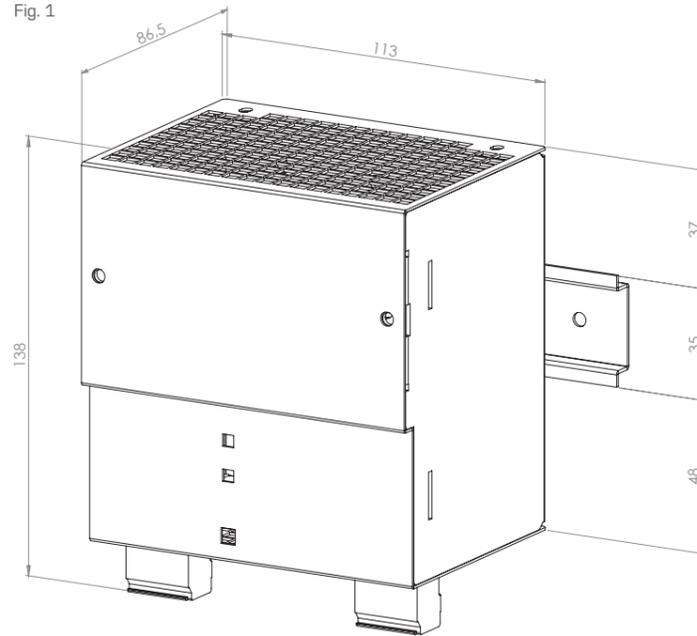
Die Stromversorgung wird mit dem an der Rückseite eingesetzten Schieber auf dem oberen Schenkel der Tragschiene TH35 angegesetzt. Die Aufrastung erfolgt durch Drücken der Stromversorgung in Richtung Tragschiene.
